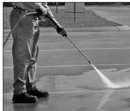
Figura 14 - Ángulo mejor para limpiar una superficie
